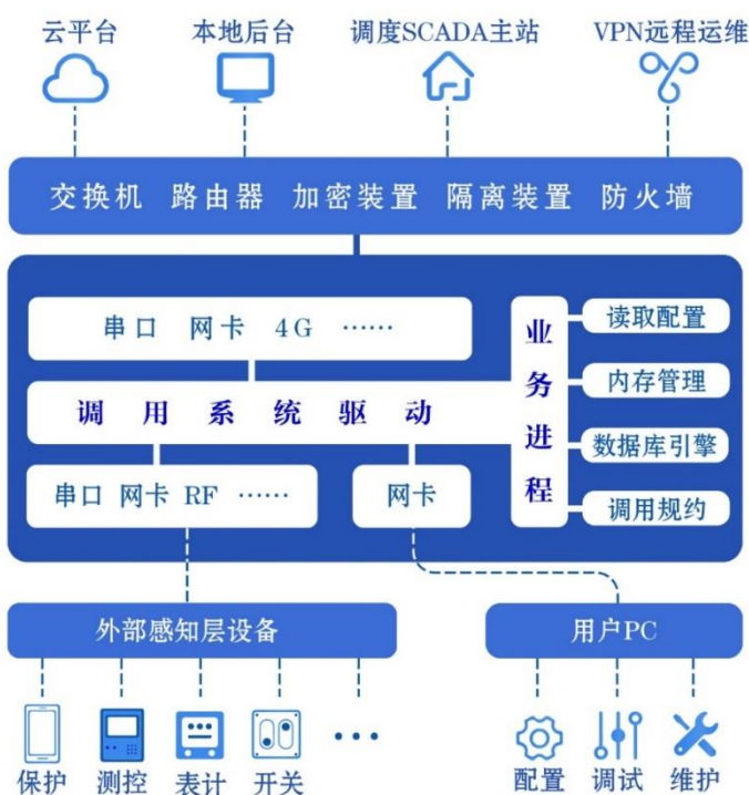
图 1-3 通讯管理机工作原理图
