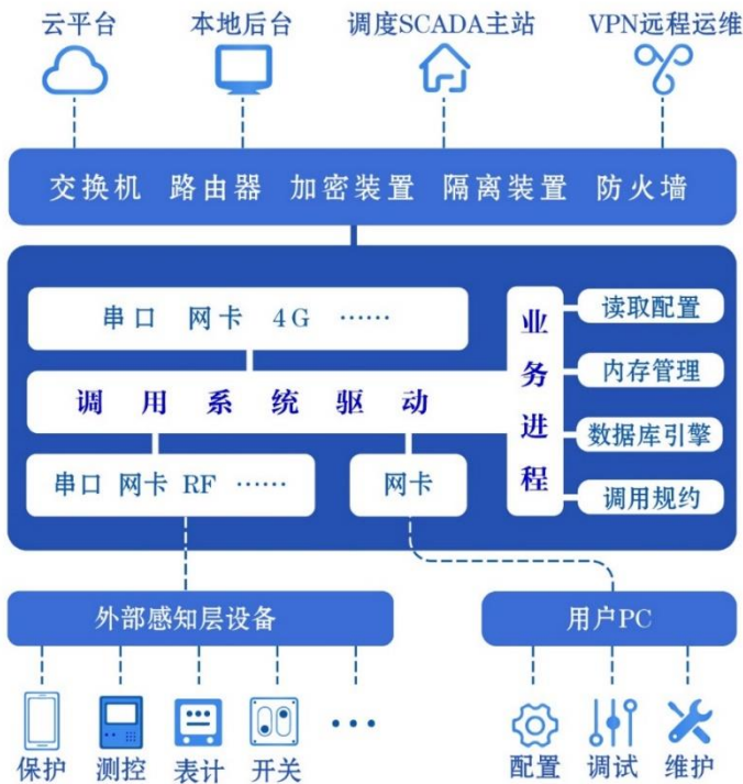
图 1-3 通讯管理机工作原理图
